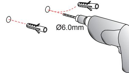
Utilisant une meche de 6mm percer les trous aux positions choisies
