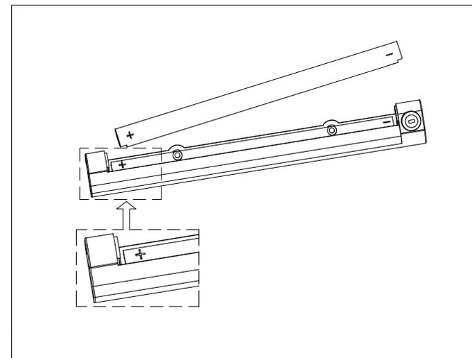
6: Engagez le compartiment à piles dans le corps de lumière LED. Assurez-vous que les signes +/- sur le compartiment coïncident avec les signes sur le corps du produit.
