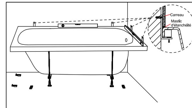
13: Remplacez la baignoire en position, fixez les équerres aux murs, puis utilisez le mastic d'étanchéité entre la baignoire et les carreaux.
