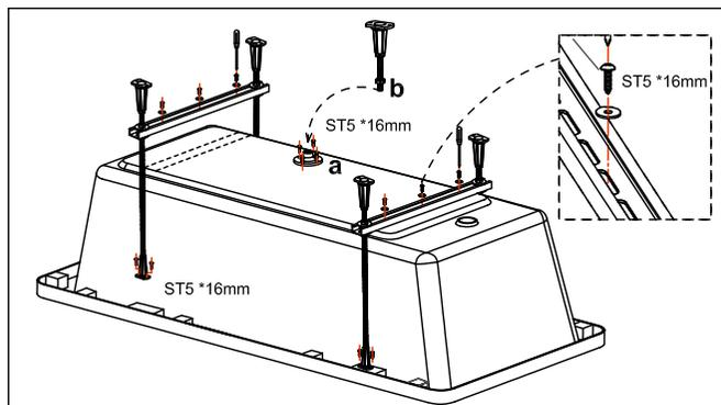
4: Retournez la baignoire et placez-la sur un tapis pour la protéger. Attachez la structure comme indiqué par la ligne pointillée et les blocs de bois. Le pied du milieu de la baignoire peut être positionné au milieu de la base.
