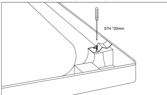
7: Fixez les clips (fournis avec le tablier de la baignoire) aux blocs sur les côtés auxquels les tabliers seront attachés.
