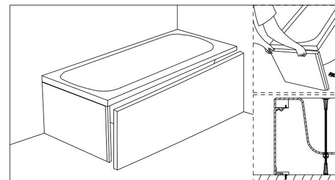
16: Attachez le tablier avec les clips en vous assurant qu'il soit fermement tenu en position par les clips en métal en haut de la baignoire. Assurez-vous aussi que les équerres au plancher empêchent le tablier d'être déplacé vers l'intérieur de la baignoire.
