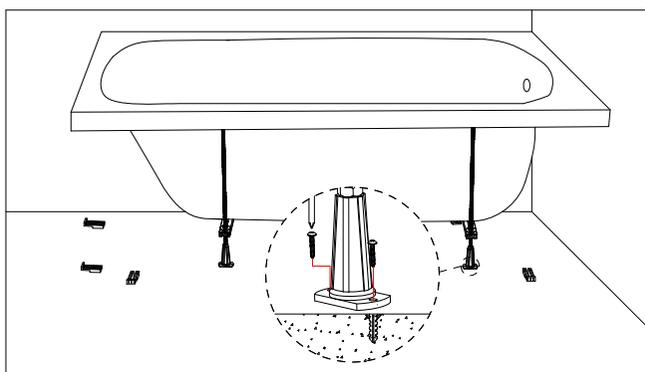
15: Une fois que la baignoire est en position, il est essentiel de fixer les pieds fermement au sol en utilisant les fixations appropriées pour le type de la surface (ces fixations ne sont pas fournies).
