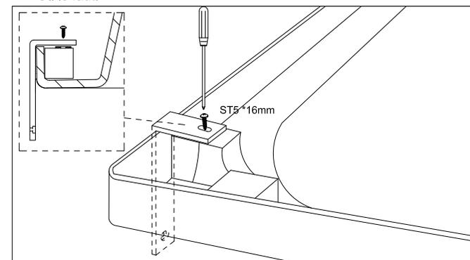
8: Fixez les équerres (fournies avec la baignoire) aux blocs sur les côtés qui seront attachés au mur.
