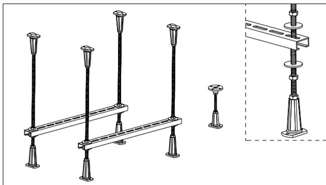
3: Montez les crémaillères, les écrous, les rondelles et la barre d'appui. Ne serrez les écrous qu'avec la main.
