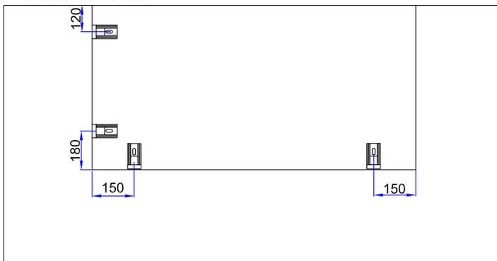
9: Les équerres sont positionnées comme sur le schéma ci-dessus. Notez que les dimensions sont en mm.
