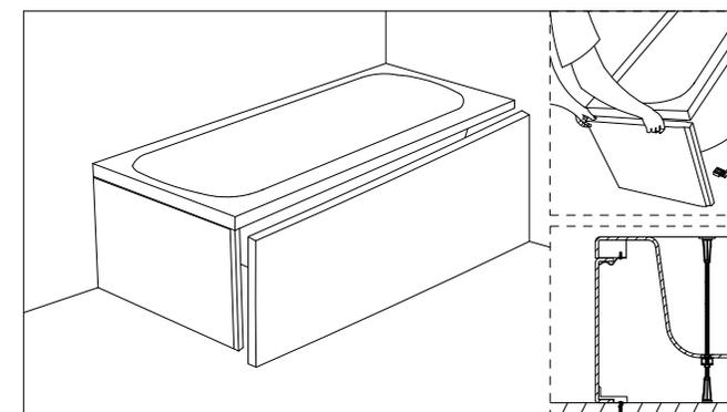
14: Fixez le tablier avec les clips en vous assurant qu'il soit fermement tenu en position par les pinces sous le bord de la baignoire. Assurez-vous que les équerres au plancher empêchent le tablier d'être déplacé vers l'intérieur de la baignoire.
