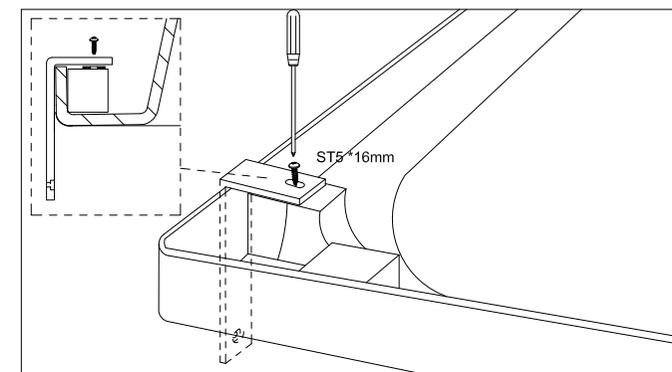
6: Fixez les équerres murales (fournies avec la baignoire) aux blocs afin de les fixer au mur. Utilisez les rondelles supplémentaires entre les équerres et les blocs si nécessaire.
