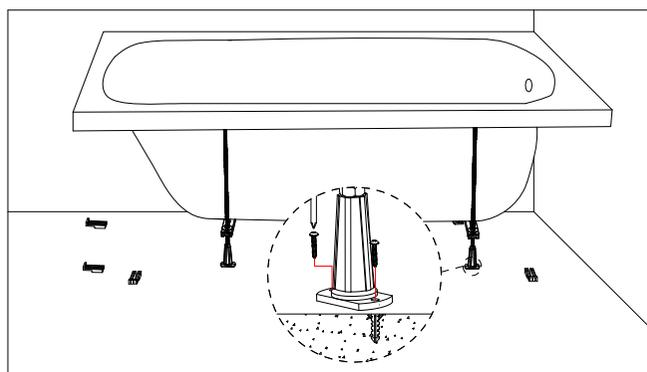
13: Une fois que la baignoire est en position, il est essentiel de fixer les pieds fermement au sol en utilisant les fixations appropriées pour le type de la surface (ces fixations ne sont pas fournies).
