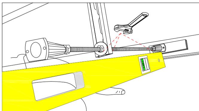
4: Vérifiez que les tiges filetées sont à niveau, au cas échéant, repositionnez la structure pour corriger. Une fois que les tiges filetées sont à niveau, serrez tous les écrous.
