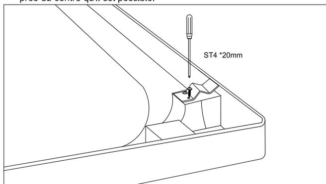
5: Fixez les clips (fournis avec le tablier de la baignoire) aux blocs se situant sous les rebords de la baignoire auxquelles le tablier sera attaché.
