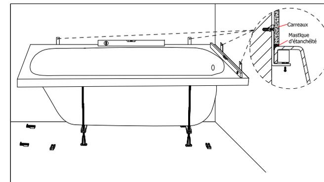
11: Remplacez la baignoire en position, fixez les équerres aux murs, puis utilisez le mastic d'étanchéité entre la baignoire et le carrelage.
