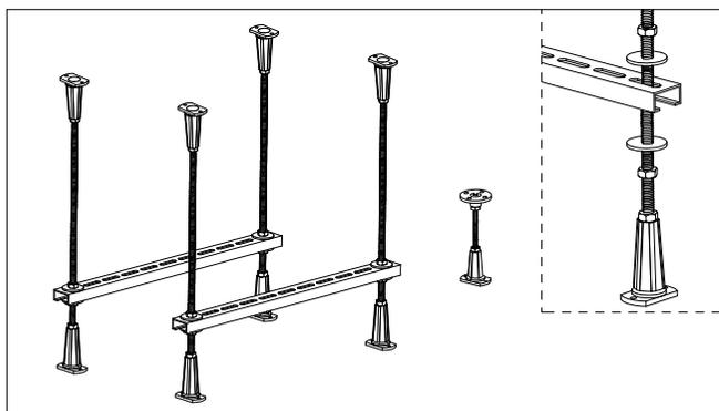
1: Assemblez les supports, les écrous, les rondelles et les crémaillères. Serrez les écrous manuellement.
