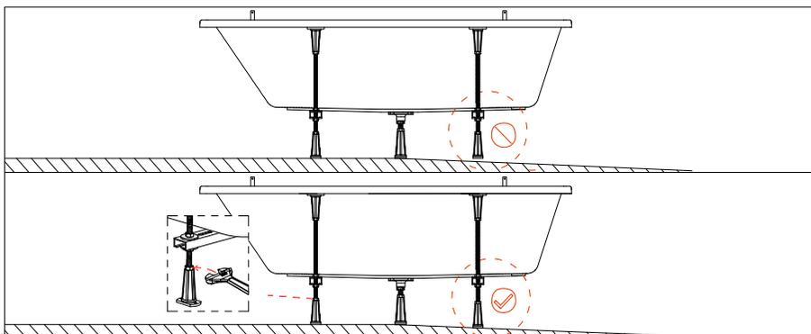
7: Placez la baignoire en position et ajuster-la pour la niveler. Déterminez les besoins d'évacuation et d'écoulement d'eau.
