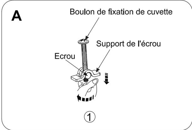
① Dévissez l'écrou du boulon de fixation de cuvette. Retirez le support de l'écrou du boulon.
