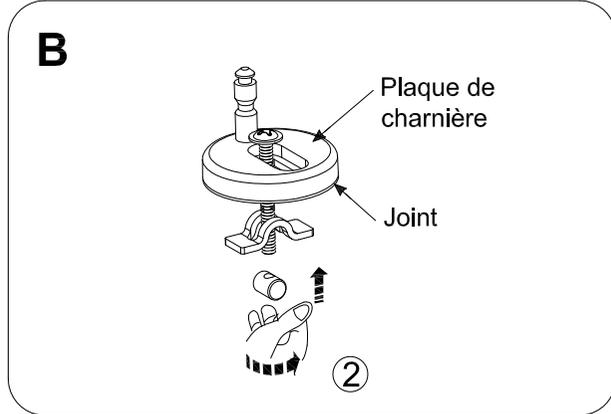
② Engagez le boulon de fixation dans la plaque de charnière et le joint. Glissez le support de l'écrou sur le boulon. Puis vissez l'écrou sur le boulon.
