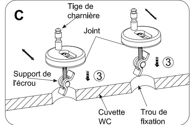
③ Tournez le support de l'écrou en position verticale et insérez-le dans le trou de fixation comme montré sur le schéma C3.
