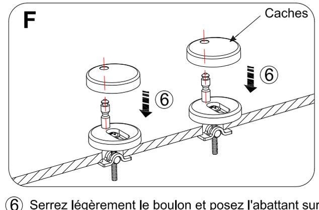
⑥ Serrez légèrement le boulon et posez l'abattant sur les tiges de la charnière. Vérifiez que l'ajustement de la plaque de charnière est correct. Si l'abattant est positionné correctement, retirez l'abattant et effectuez la fixation finale des boulons pour éviter que l'abattant bouge ou bien les fixations se relâchent. Couvrez les plaques de charnière avec les caches comme montré sur le schéma F 6.
