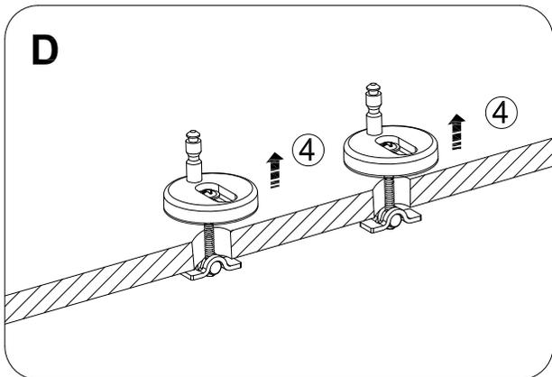
④ Une fois inséré, secouez légèrement le boulon pour que le support de boulon se mette en position horizontale. Une fois que le support de l'écrou est horizontal, soulevez la plaque de charnière et le boulon afin que le support de boulon soit fermement tenu en position par le dessous de la cuvette céramique (comme montré sur le schéma D 4).
