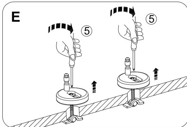
⑤ Tout en maintenant la plaque de charnière et en serrant le support de l'écrou contre le dessous de la cuvette, serrez le boulon à l'aide d'un tournevis - comme montré sur le schéma E 5. Le boulon va se serrer et la plaque de la charnière va descendre jusqu'à ce qu'elle soit fermement collée à la cuvette.
