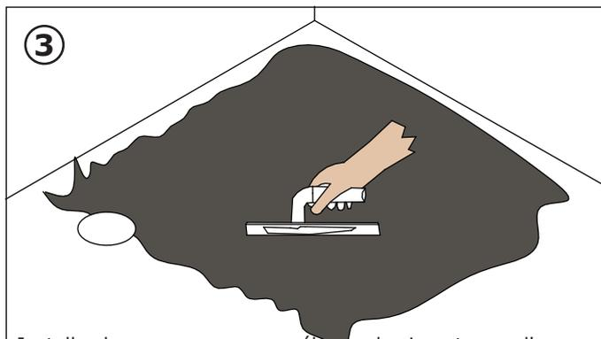
Installez le receveur sur un mélange de ciment mou d'une profondeur de 15 mm (proportions sable/ciment 5:1). L'adhésif pour les tuiles peut être utilisé comme alternative au sable ou ciment. Veuillez noter que si vous utilisez des adhésifs à base d'eau, afin d'améliorer l'adhérence, il est recommandé d'appliquer un apprêt adapté à la base du receveur avant l'installation.
