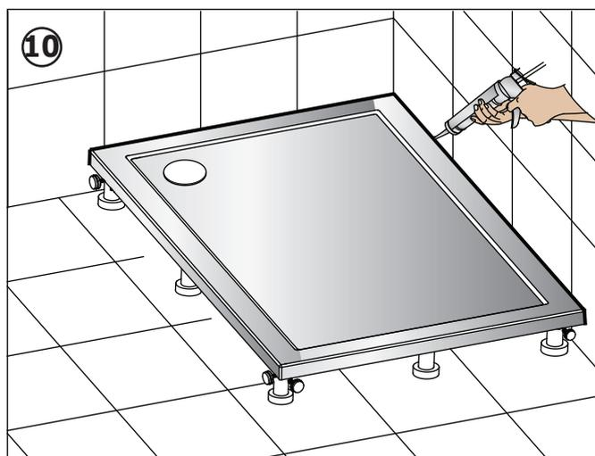
Carrez le mur et scellez les jointures avec un mastic antifongique à base de silicone et laissez prendre.
