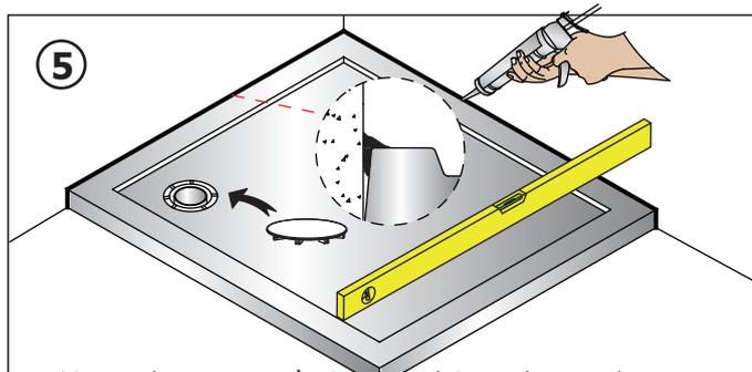
Ajustez le receveur à niveau et laissez-le prendre. Lorsque le receveur est bien fixé, enlevez le reste de film plastique protecteur et raccordez le tuyau du vidage, puis vérifiez s'il n'y a pas de fuites.
