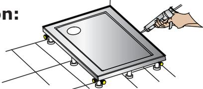
Carrez le mur et scellez les jointures avec un mastic antifongique à base de silicone et laissez prendre.
