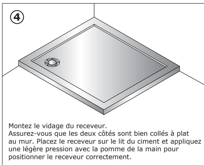
Montez le vidage du receveur. Assurez-vous que les deux côtés sont bien collés à plat au mur. Placez le receveur sur le lit de ciment et appliquez une légère pression avec la pomme de la main pour positionner le receveur correctement.
