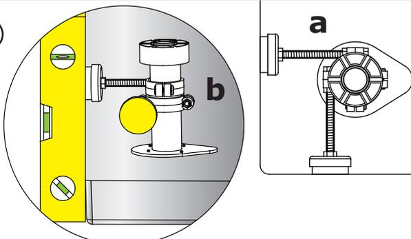
a: Assurez-vous que les fixations pour panneaux soient positionnées à 90° par rapport au bord du receveur, comme indiqué sur le dessin ci-dessus.
