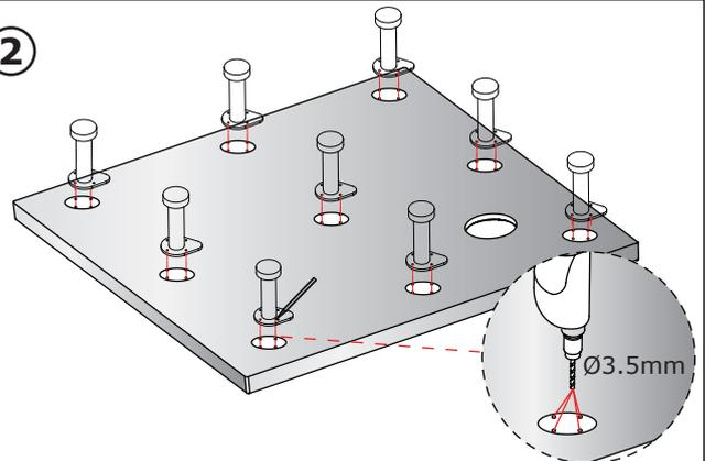
En utilisant le pied comme exemple, marquez les positions des trous de fixation avec un crayon. Ensuite en utilisant un foret de 3,5 mm de diamètre, percez un trou de profondeur maximale de 5mm.
